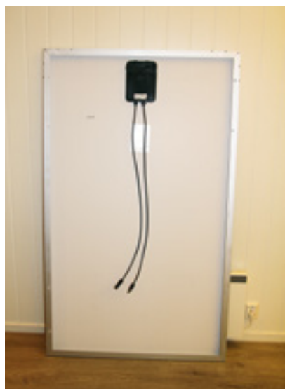
Slik sitter Optimizeren på solcellepanelet, og slik ser den ut på nært hold.
